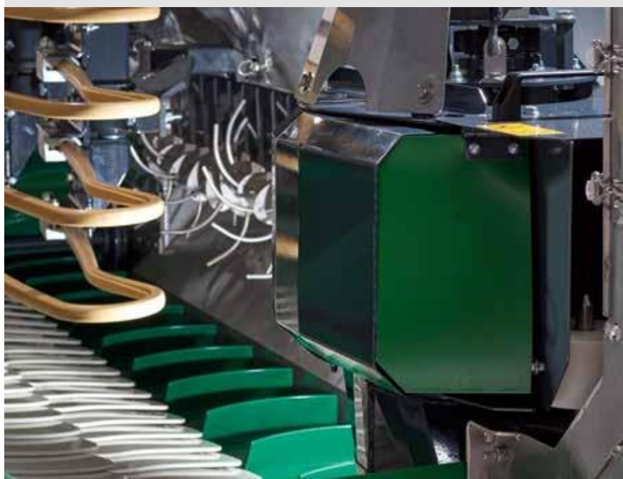
Poboljšani donji usisni ventilator sa fleksibilnom zavesom.
